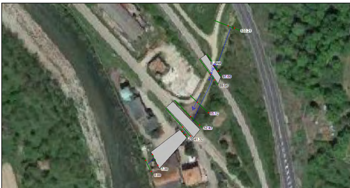
Figura 6. Schema planimetrico del modello idraulico: "B-Brelle" su foto aerea.
