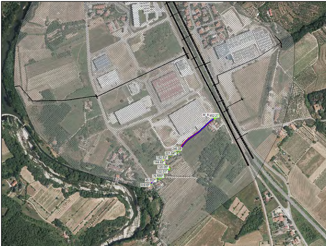
Figura 17. Schema planimetrico del modello idraulico "M-Mercato" su foto aerea.
