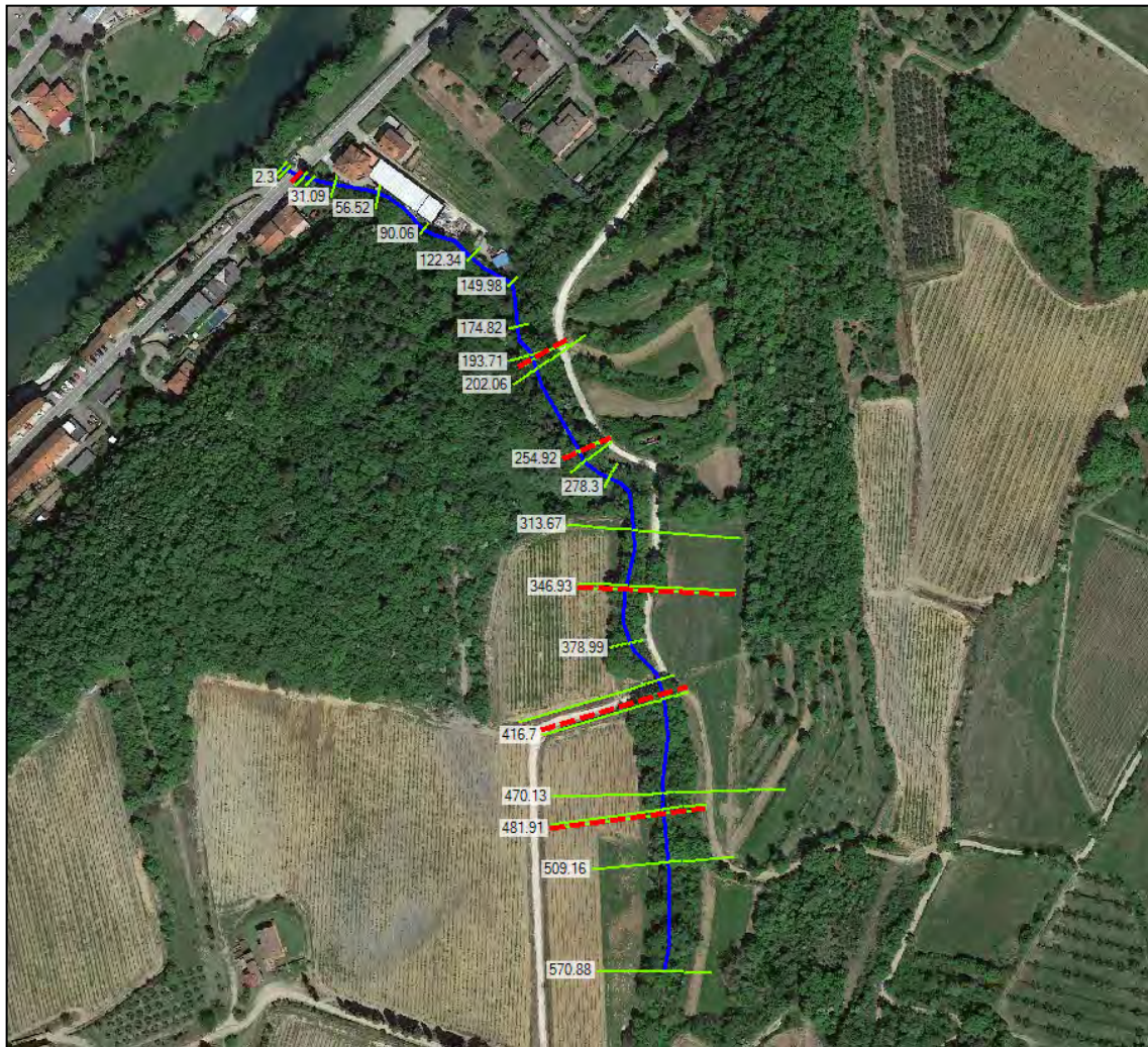
Figura 14. Schema planimetrico del modello idraulico "I-Fossatello" su foto aerea.
