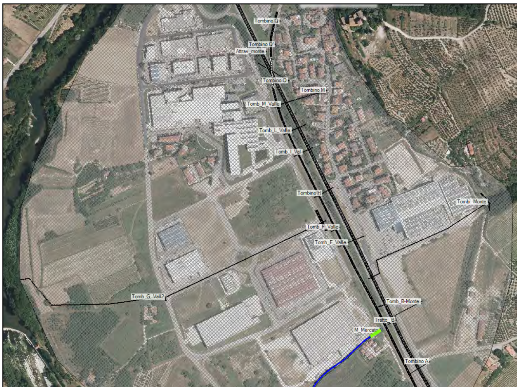
Figura 18. Modello idraulico " L+M-Castello+Mercato" su foto aerea - particolare sistema di drenaggio.
