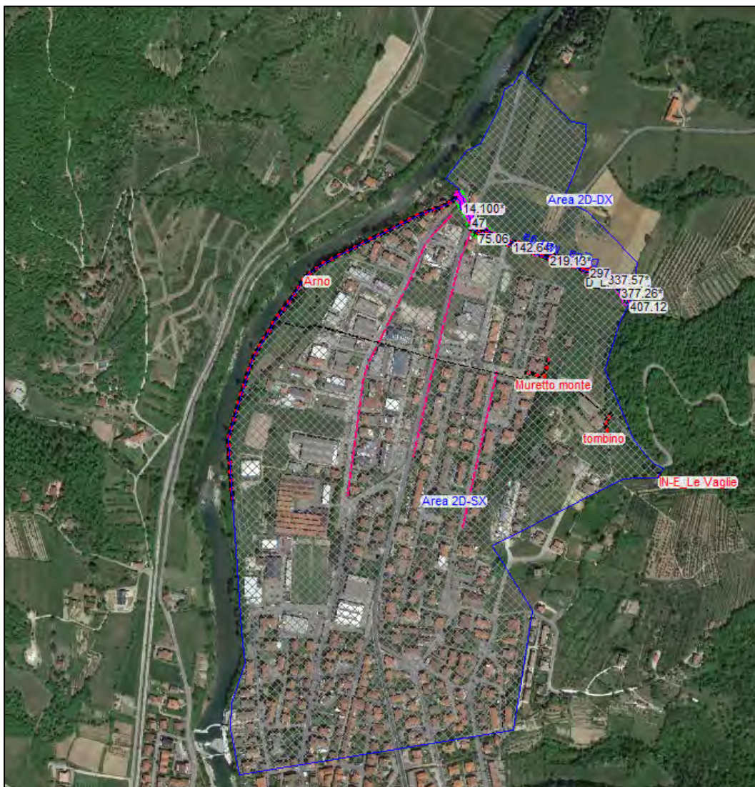
Figura 8. Schema planimetrico del modello idraulico: "D+E-La Marga-Le Vaglie" su foto aerea.
