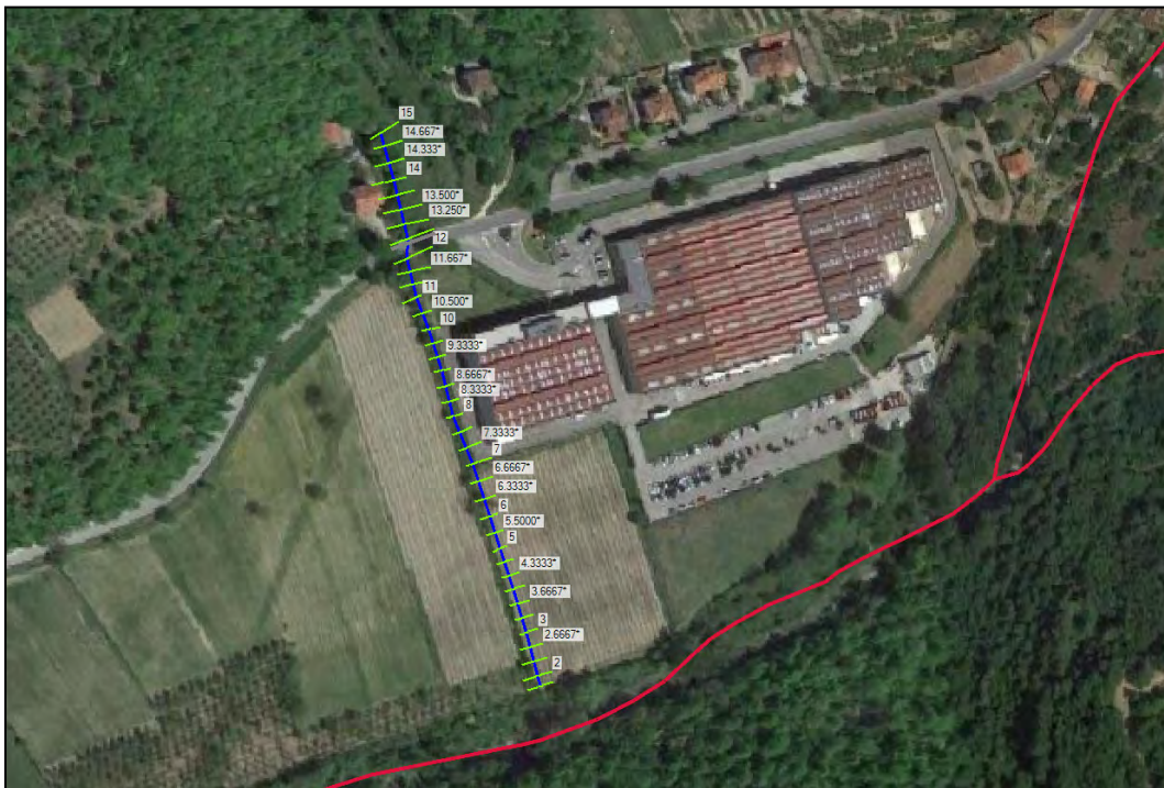
Figura 23. Schema planimetrico del modello idraulico " R-S. Margherita" su foto aerea.
