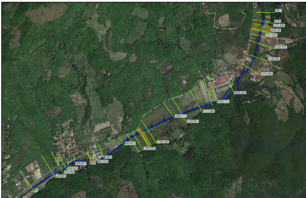
Figura 25. Schema planimetrico del modello idraulico " S-Chiassa" foto aerea.
