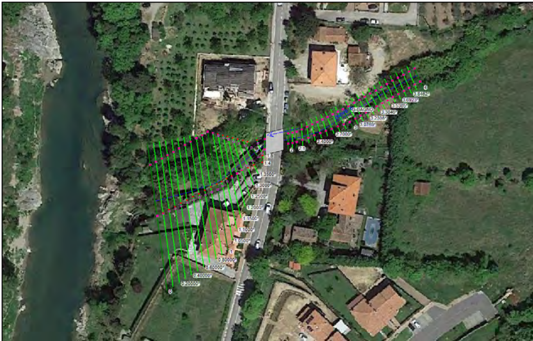
Figura 11. Schema planimetrico del modello idraulico "G-Bagno" su foto aerea.
